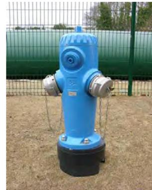
*Poteau d'aspiration de 150 mm muni de deux sorties de 100 mm et d'un carré de manœuvre*
