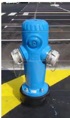
*Poteau d'aspiration à réseau sec de 150 mm, muni de deux sorties de 100 mm. et d'un Airclap.
