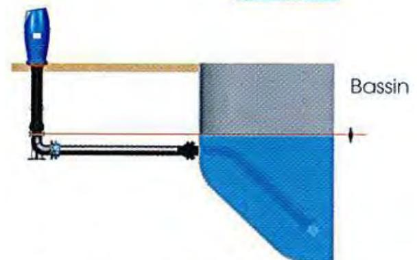
Principe d'implantation d'un poteau d'aspiration à réseau sec
